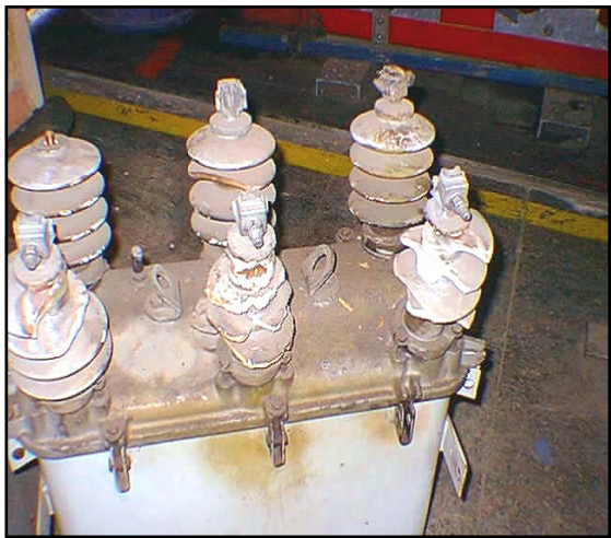
Fig. 4.6b. Reconectores con aisladores dañados por efectos de fallas y condiciones ambientales.
