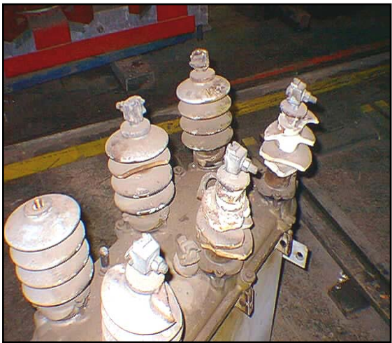
Fig. 4.6b. Reconectores con aisladores dañados por efectos de fallas y condiciones ambientales.
