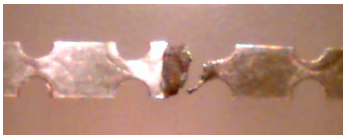
Fig. 4.2.4c. Lámina fusible que fue sometida a un régimen de sobrecarga.
