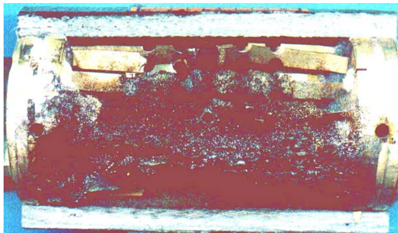
Fig. 4.3.3. Corte transversal de un fusible quemado con 2000 A. El uso de un medio de extinción del arco inapropiado, reducirá la capacidad de ruptura del fusible.
