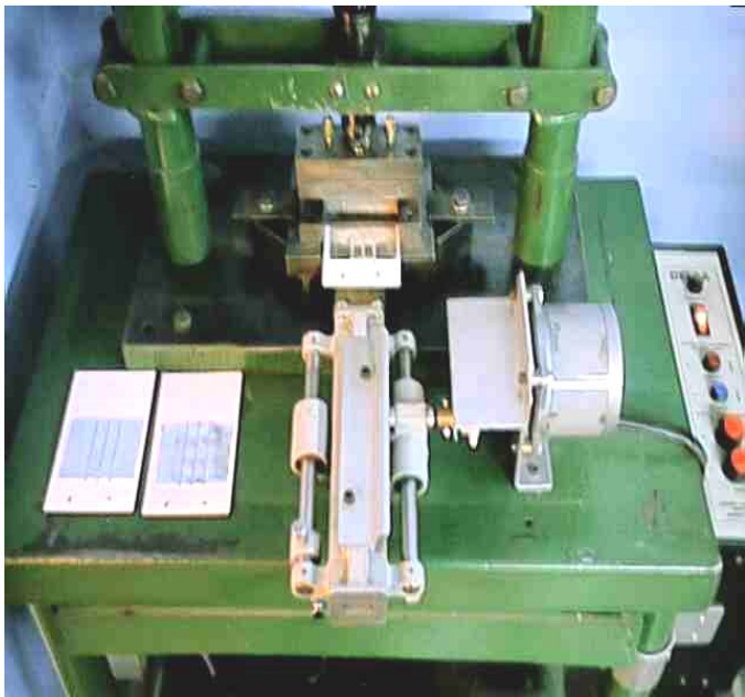
Fig. 4.2.3.c. A la izquierda, máquina utilizada para la perforación de láminas, modelo PB 1300. A la derecha, dibujo explicativo de una lámina con 4 venas, 3 filas y 5 perforaciones.
