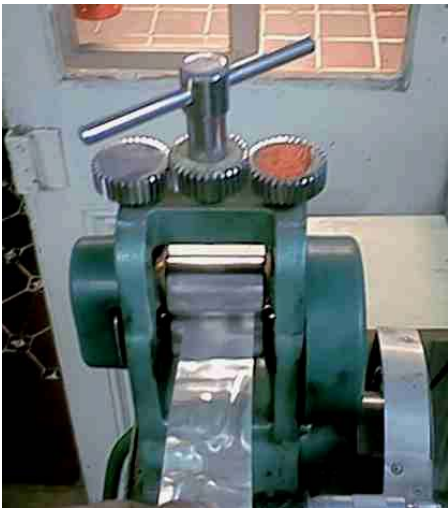
Fig. 4.2.3b. Máquina laminadora implementada para rebajar el espesor de las láminas a utilizar en fusibles.
