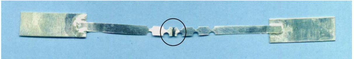
Fig. 4.2.4a. Lámina fusible con Pastilla de Difusión o Carga Térmica.
